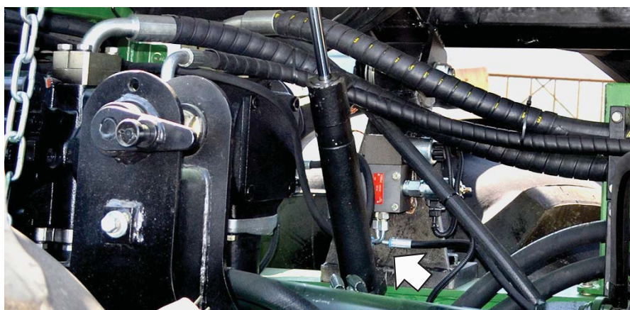
Рисунок 3.67 — Расположение блока клапанов насоса привода харвестерной головки
