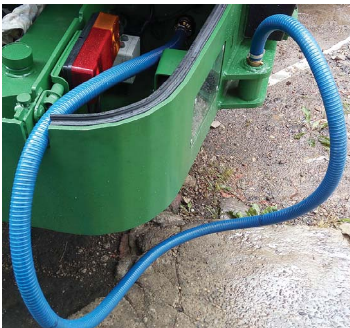
Рисунок 4.3 — Подключение шланга заправки топливом
