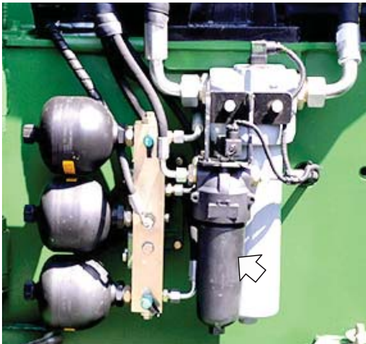
Рисунок 3.72 — Расположение фильтра гидросистемы тормозов
