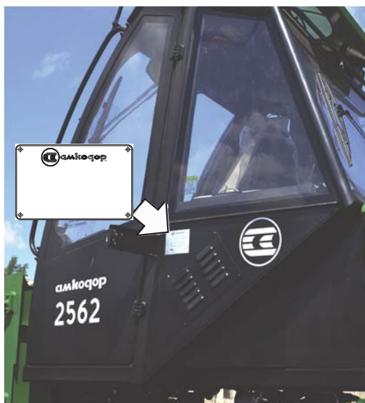
Рисунок 2.5 — Расположение маркировочной таблички кабины
