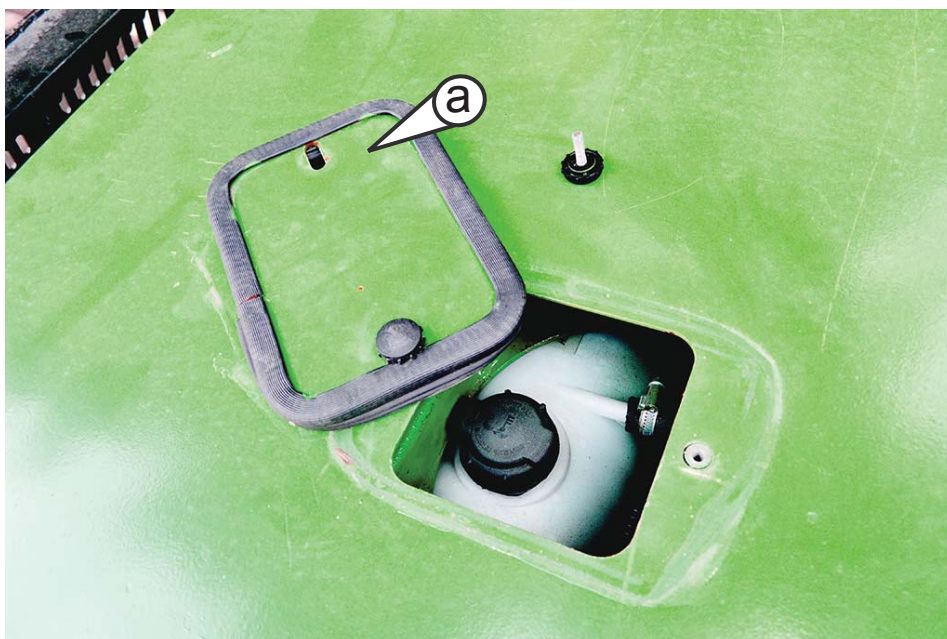
Рисунок 4.10 — Доступ к заливной горловине расширительного бачка
