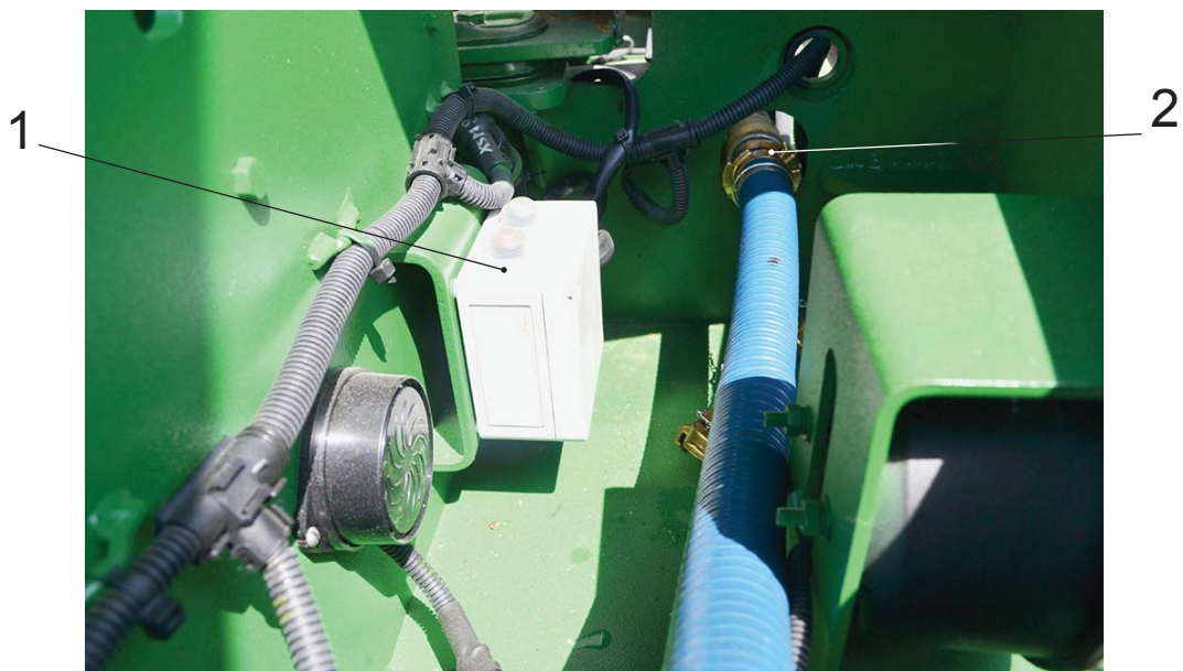
1 – пульт управления; 2 – легкоразъемный фланец подсоединения шланга для заправки топливом Рисунок 4.2 — Место управления и подключения шланга заправки топливом
