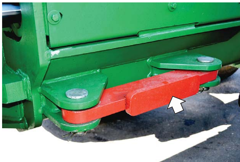
Рисунок 4.17 — Транспортное положение звена безопасности
