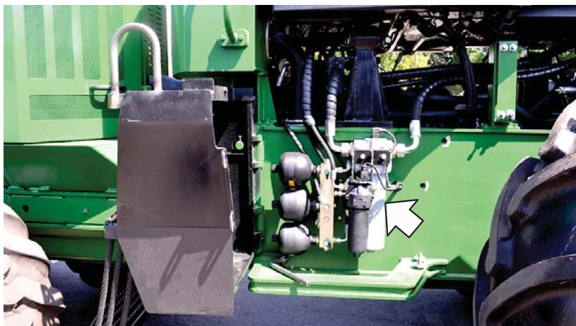
Рисунок 3.63 — Расположение напорного фильтра
