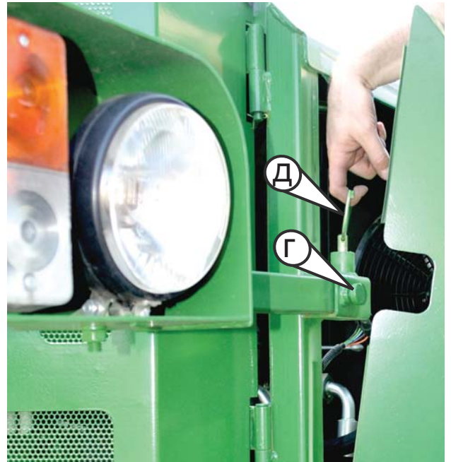
Рисунок 3.80 — Установка и снятие кронштейнов фар транспортного освещения
