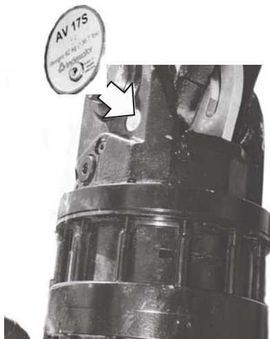
Рисунок 2.9 — Расположение маркировочной таблички ротатора
